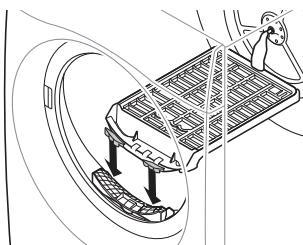
仔细检查过滤器孔并插入支架。如果将支架略微推入滚筒内，安装将会更贴合。
