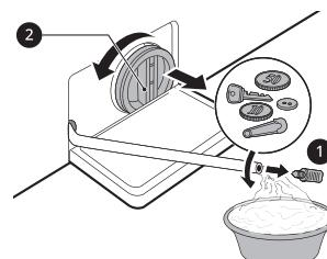
**4** 清洁排水泵过滤器后，请将过滤器重新插入并将排水盖顺时针拧回，以避免螺纹错扣和泄漏。将排水塞重新插回排水管，然后将排水管放入其支架中。
