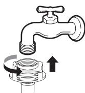
2 下拉接头插销板，将进水管推到接头上，并松开接头插销板。请确保将接头锁定到位。
