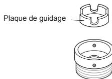
**3** Pousser l'adaptateur dans l'extrémité du robinet afin que le joint en caoutchouc forme une liaison étanche. Serrer les quatre vis de fixation.
