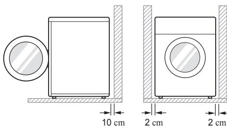
**Niveau du sol :** La pente admissible sous la totalité de l'appareil est de 1°.
