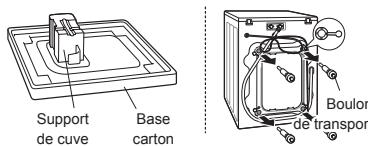
Enlever les boulons de transport et le support de cuve.
