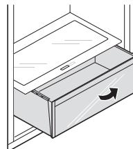
**3** Ensamble el cajón de verduras siguiendo los pasos del proceso de extracción en orden inverso.
