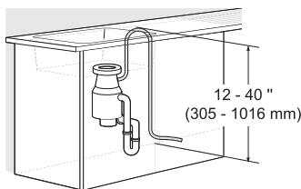
**Conexión al triturador sin trampa de aire**
