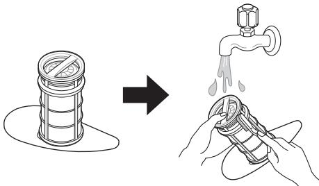
**4** Para reemplazar los filtros ensamblados, coloque el brazo pulverizador de manera que la V más amplia esté hacia el frente. Vuelva a ajustar los filtros en sus respectivos soportes y
