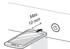
**3** 按住 **温度** 按钮 3 秒或更长时间，同时将智能手机麦克风保持在靠近 **电源** 按钮的地方，直至完成数据传输。
