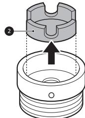
3 将接头往上推至水龙头末端，从而使橡胶密封圈形成紧密连接。拧紧 4 个固定螺丝。
