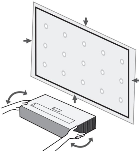
**3** Pour régler la mise au point de l'image, ajustez lentement la bague de mise au point à gauche ou à droite lorsque vous regardez en haut au centre de l'écran. Vous pouvez régler la mise au point de manière plus efficace lorsque les écrans gauche et droit sont équilibrés. Lors du réglage de la mise au point sur l'écran, vérifiez que le produit est stable.
