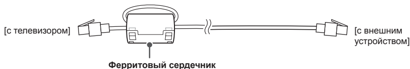
[Вид ферритового сердечника в разрезе]
