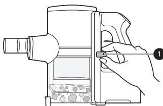
**3** Appuyez sur le bouton de déverrouillage du couvercle du bac à poussière **❷** pour l'ouvrir. Secouez le bac à poussière pour le vider.
