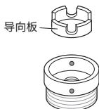
3 将接头往上推至水龙头末端, 从而使橡胶密封圈形成水密连接。拧紧四颗固定螺丝和接头环板。
