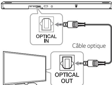
2. Réglez la sortie sonore du téléviseur pour écouter le son par le biais de cette unité : menu des paramètres du téléviseur → [Son] → [Sortie son de la télévision] → [LG Sound Sync (Optique)].
