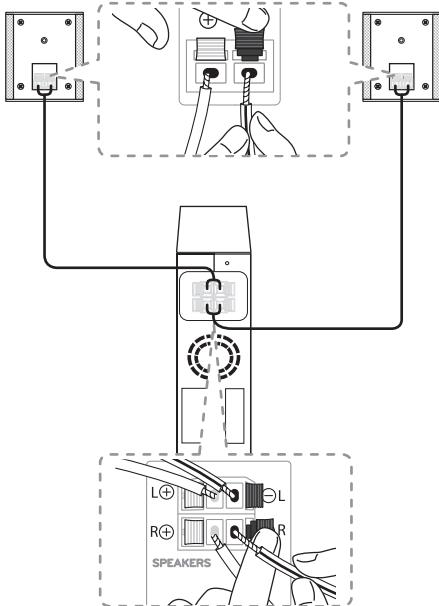
2. Connectez le récepteur sans fil et les enceintes arrière (droite, gauche) aux câbles des enceintes.
