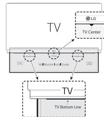
2. Si vous fixez la barre de son sur un mur en béton, utilisez des chevilles. Vous devrez percer des trous. Un feuillet de guide (un guide d'installation du support mural) est fourni pour forer. Utilisez-le pour marquer les points où percer.
