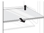
**2** При установке сдвигайте полку внутрь до тех пор, пока она не встанет по месту в рамке.
