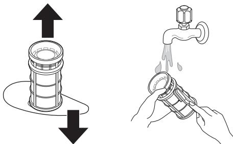
4 Pour remonter les filtres assemblés, positionnez le bras gicleur inférieur de sorte que le grand V soit orienté vers l'avant. Remontez les filtres dans le porte-filtre et fixez-les en tournant le filtre interne dans le sens des aiguilles d'une montre jusqu'à ce qu'il se verrouille en place.
