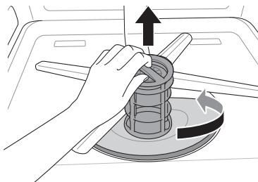
3 Nettoyez les filtres avec une brosse douce sous l'eau courante. Remontez les filtres avant de les réinstaller.
