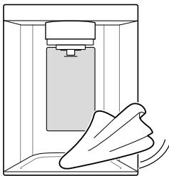
indiquée à l'intérieur du réservoir de distribution d'eau. (Capacité totale : 4 l)
