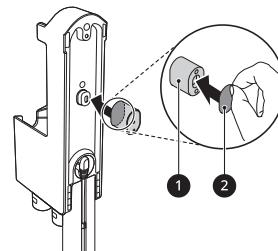
**2** Закрепите вторую часть двустороннего скотча на другой стороне крепежного блока для стены, чтобы закрепить его на стене.
