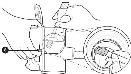
3 Приподнимите фильтр предварительной очистки 3 и выньте его из корпуса прибора.
