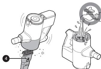
5 Очищайте фильтры от пыли с помощью щетки и промывайте их в проточной воде не реже одного раза в месяц.
