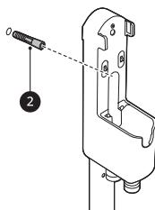
**7** Выровняйте крепежный блок для стены **3** зарядной станции и закрепите зарядную станцию на стене, затянув крепежный винт **4** до упора.
