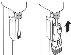
отсоединения телескопической трубы **2**.
