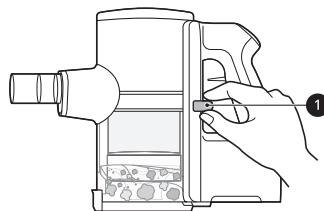
**3** Нажмите кнопку разблокировки крышки пылесборника ② и откройте крышку. Опустошите пылесборник, встряхивая его.
