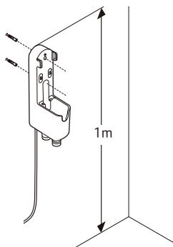
3 Закрепите зарядную станцию на стене крепежными винтами.
