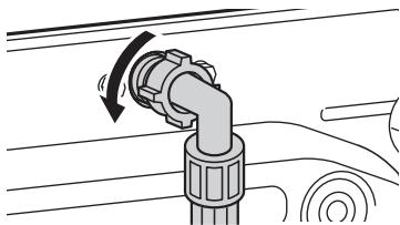
**2** 用小钳子拆下进水过滤器，然后使用中等硬度牙刷清理过滤器。
