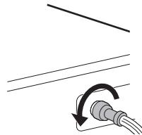
**2** Retire el filtro de entrada de agua con pinzas pequeñas y luego limpie el filtro utilizando un cepillo de diente de cerdas medianas.
