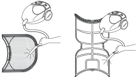
**3** Si el filtro de pelusa se ha ensuciado mucho o se ha obstruido con suavizante de ropa, lávolo en agua tibia jabonosa y déjelo secar completamente antes de volver a colocarlo.
