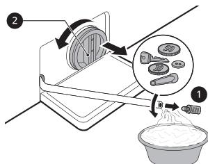
**4** Despues de la limpieza del filtro de la bomba de drenaje, reinserte cuidadosamente el filtro y
