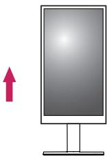
2 按图示箭头的方向调节显示器的角度。
