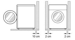
**Sklon podlahy**: Povolený sklon podlahy pod celým zařízením je 1°.
