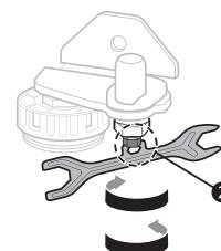
3. 调整冰箱门高度差异后, 逆时针旋转止动螺母以将其拧紧。
