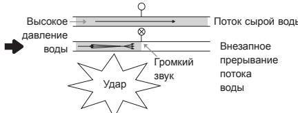
Отрегулируйте давление воды, прикрыв водяной клапан или кран.
