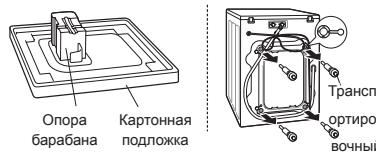
Снимите транспортировочные болты и опоры.
