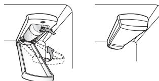
**5** Luego de reemplazar el filtro de agua, dispense 2.5 galones de agua (deje correr el agua por aproximadamente 5 minutos) para remover el aire atrapado y los contaminantes del sistema.
