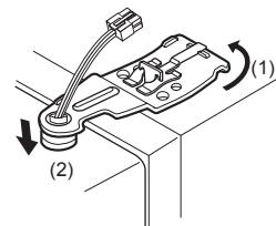
**3** Vuelva a conectar todos los arneses. Enganche la pestaña en el interruptor lateral de la tapa, debajo del borde de la apertura en la parte de arriba del gabinete. Coloque la tapa y reemplace el
