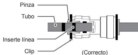
**2** Presione suavemente la pinza e inserte el tubo hasta que únicamente una línea se muestre en él.
