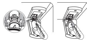
**4** Gire el filtro de agua hacia arriba en su posición y cierre la cubierta. La cubierta hará clic cuando esté cerrada correctamente.
