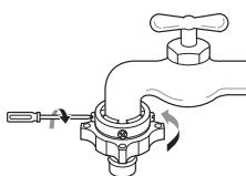
4 下拉接头插销板，将进水管推到接头上，并松开接头插销板。请确保将接头锁定到位。
