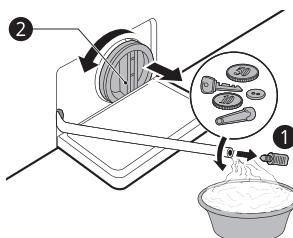
4 清理完排水泵过滤器后, 取出排水泵过滤器并插入排水塞。
