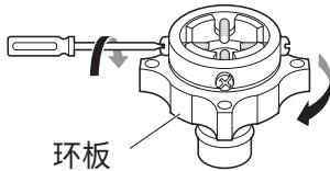
2 如果水龙头过大而与接头不匹配，请拆下导向板。
