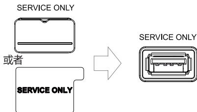
2 当显示器屏幕正常运行时，将包含升级软件的 USB 存储设备插入 USB 端口 (
