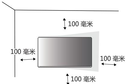
若要将显示器安装到墙上，请将壁挂支架（可选）连接到显示器背面。
