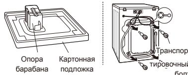
Снимите транспортировочные болты и опоры.
