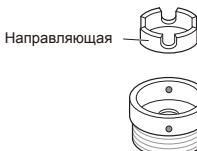
3 Наденьте адаптер на конец крана так, чтобы резиновое уплотнение создало герметичное соединение. Затяните четыре крепежных винта.
