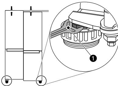
2 使用扳手②向左 / 向右转动调节铰链销可以调节高度。
