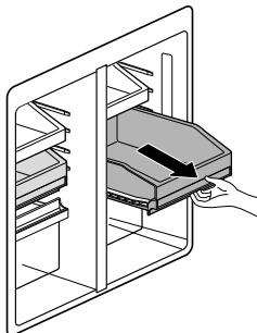
将搁板前半部分推入搁板后半部分下方，可存放较高的物品，例如容量在一升以上的容器或瓶子。将搁板前半部分拉出，可恢复完整搁板形态。
