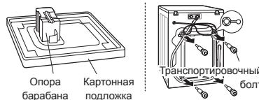
Снимите транспортируочные болты и опоры.
