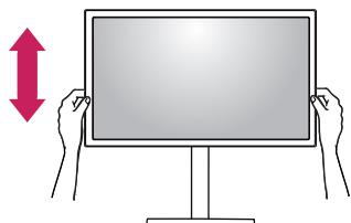
**2** 最高可将高度调整至 120.0 毫米。
