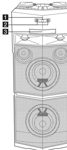
**1 R** (Датчик сигналов ПДУ)**2** Разъем MIC (Микрофон) 1/2**3** Лоток для дисков
