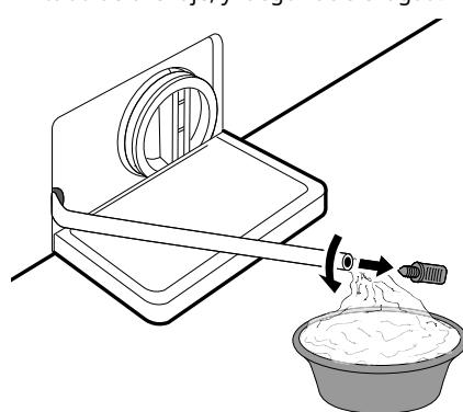
**4** Desatornille el filtro de la bomba de drenaje lentamente para vaciar el agua restante y luego proceda a eliminar cualesquier residuos u objetos del filtro.
