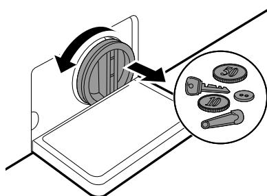
**5** Despues de la limpieza del filtro de la bomba de drenaje, reinserте cuidadosamente el filtro y atornille la tapa de drenaje en el sentido de las agujas del reloj con cuidado para evitar daños a la rosca y fugas. Reinserte el tapón en el tubo de drenaje y coloque el tubo en su soporte.
